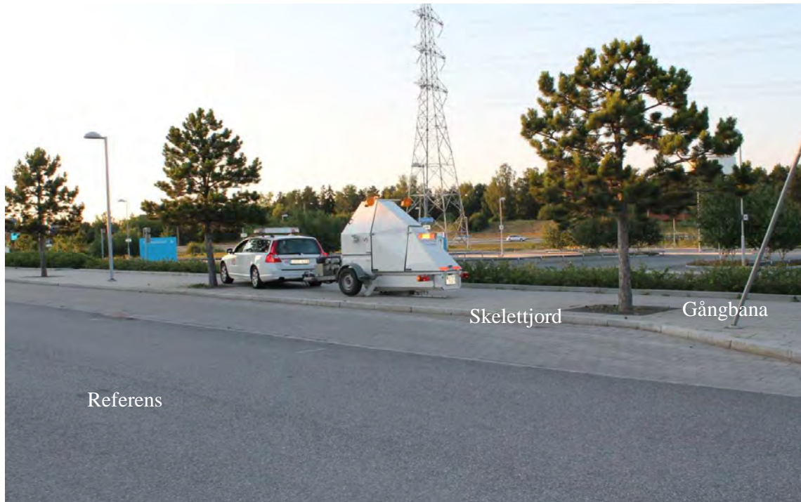
Figur 30. Fallviktsmätning via Massgatan, Kista.
