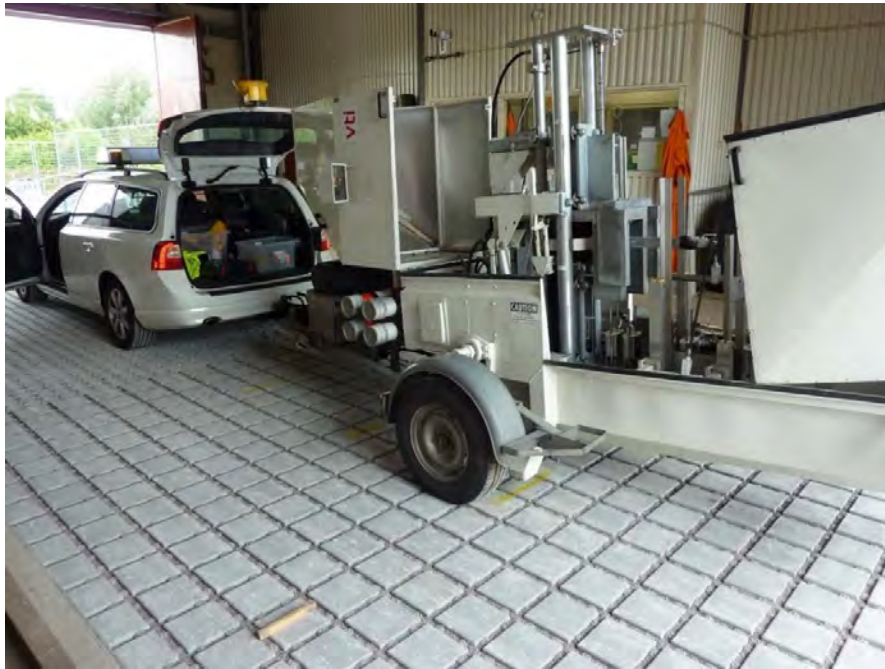
Figur 2. Fallviktsmätning före HVS test.
