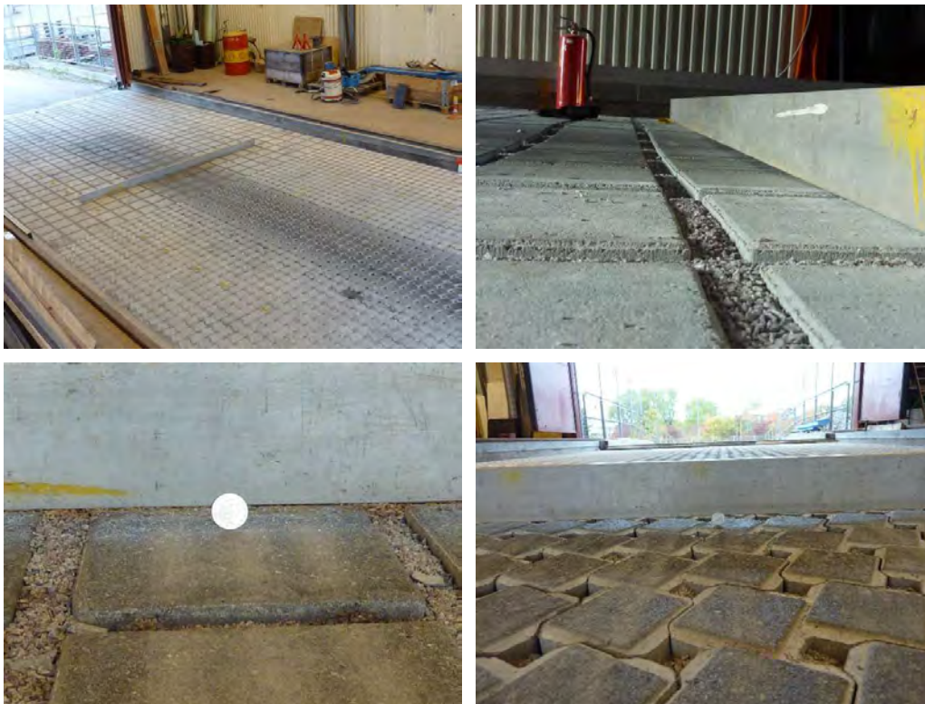
Figur 10. De dränerande ytorna efter HVS test. Bilderna visar spårdjupet.
