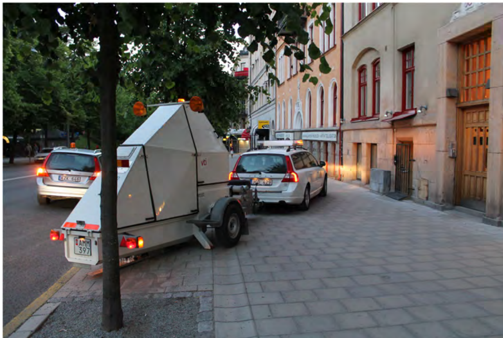
Figur 29. Fallviktsmätning vid Odengatan 86 i Stockholm.
