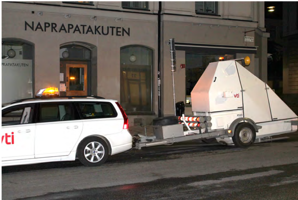
Figur 28. Fallviktsmätning vid Norrtullgatan i Stockholm.
