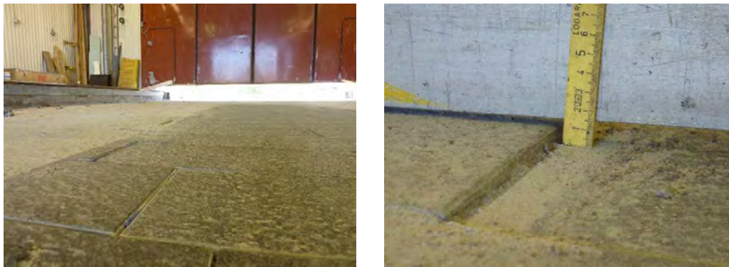
Figur 16. Höjdskillnad mellan naturstenarna uppstod efter belastning av HVS hjulet.
