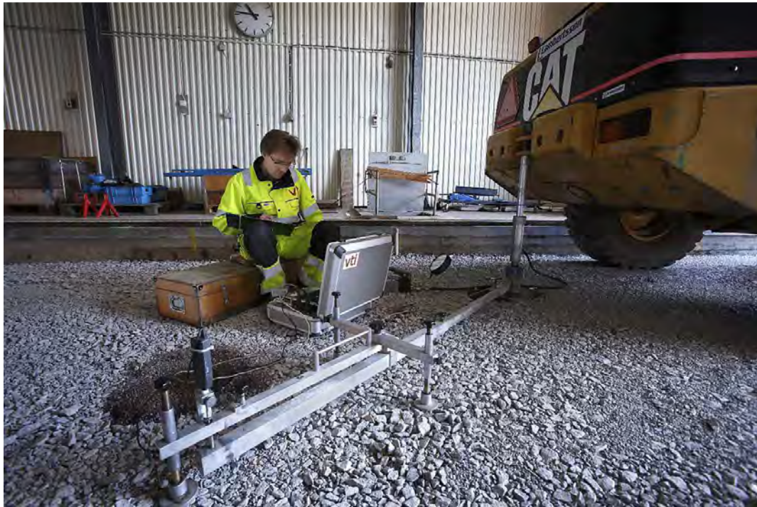
Figur 4. Plattbelastning på bärlageryta.
