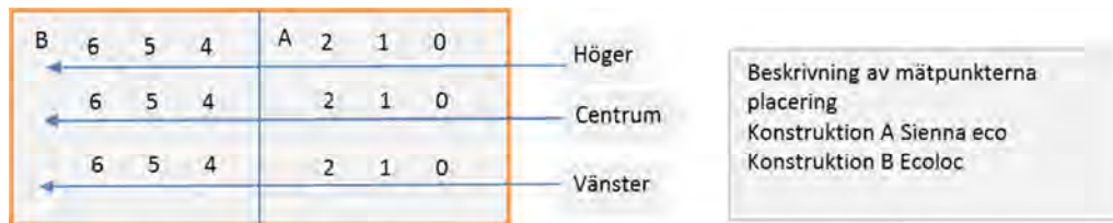
Figur 3. Fallviktens mätpunkter för D0 på mätytan.
